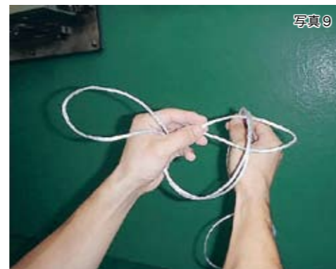
⑦結び目を持ち、長く余っている部分を手前から奥へ右側の輪にかけ(写真9)
