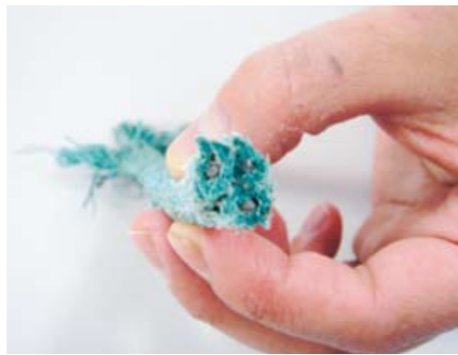
縄の断面写真(縄の中心に鉛の芯が含まれている)
